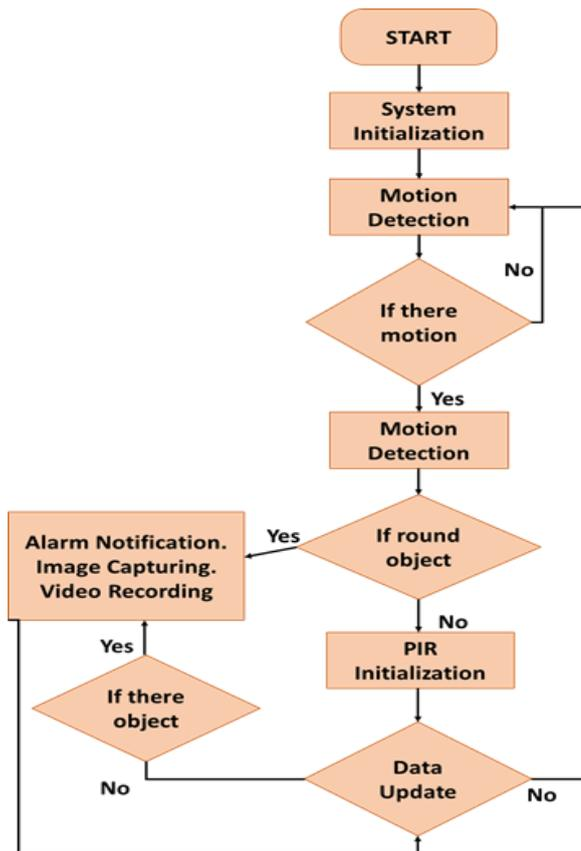
Fig. (4): System Flow Diagram (ATS-IoT)
