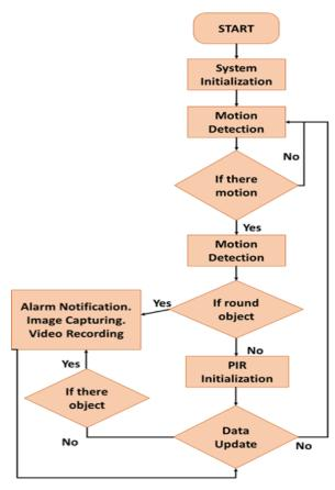
Fig. (4): System Flow Diagram (ATS-IoT)
